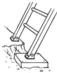
Figure 2 : Calage de mise à niveau pour la base de l'escabeau sur un terrain inégal
