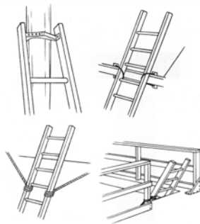
Figure 4 : Stabilisation du sommet d'une échelle portable
