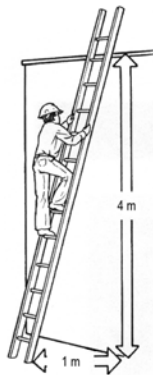
Figure 5 : Installation correcte de l'échelle
