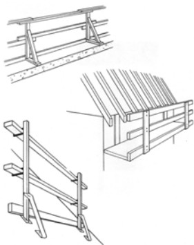
Figure 7 : Systèmes appropriés de garde-corps
