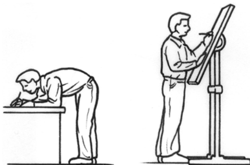
Figure 5 : Un plan de travail plus grand et inclinable élimine les positions contraignantes
