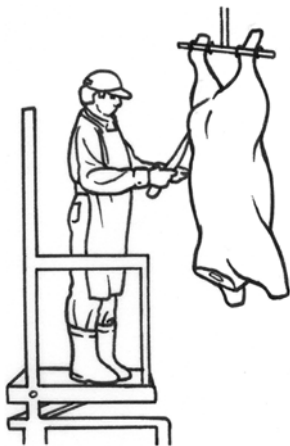
Figure 6 : Une plateforme de travail élevée réduit les extensions contraignantes des bras au-dessus de la tête.
