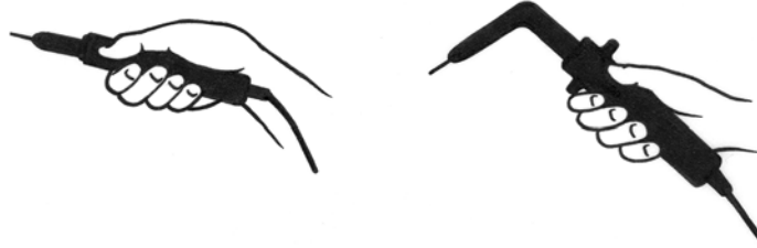
Figure 7 : Un outil coudé élimine les mauvaises positions du poignet et permet une manipulation plus facile
