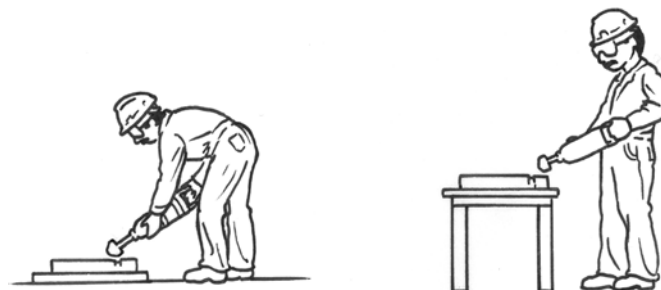
Figure 3 : Une plateforme de travail surélevée peut éliminer les postures contraignantes
